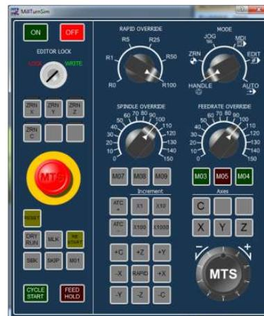
Der **Lock/Write-Schlüsselschalter** zwischen den Tastern [ON] / [OFF] und [Not-Aus] muss auf „Write“ stehen, um eine Änderung in einem NC-Programm durchführen zu können (dies schließt unbeabsichtigte NC-Programmveränderungen durch Maschinenbediener aus).
